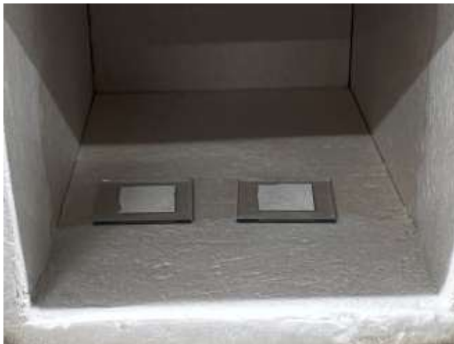
② ITOガラス基板に酸化チタンペースを塗って焼く
